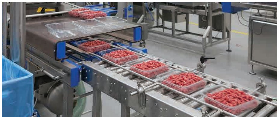
2. kép. Darálthús ipari vákuumcsomagolása mélyhúzó csomagológépen
